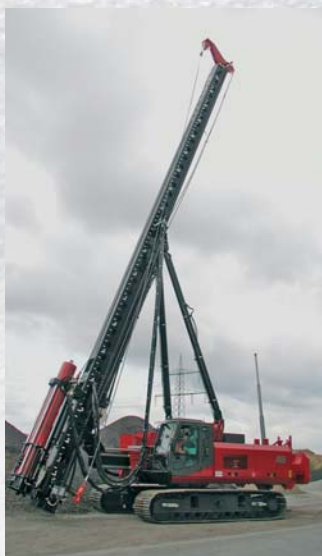
BANUT 555 при складывании, вспомогательный устанавливающий цилиндр выдвинут
