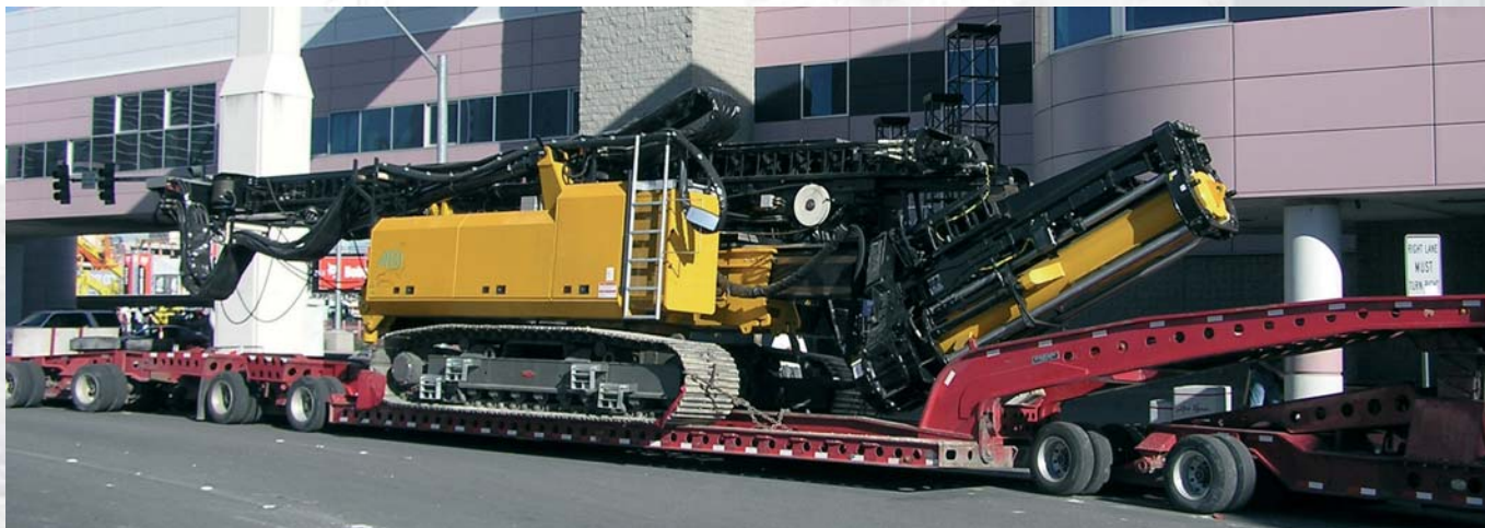
Копёр с жёсткой мачтой BANUT 650 с гидравлическим свободнопадающим молотом SuperRAM 6000XL в транспортном положении на низкой грузовой платформе
