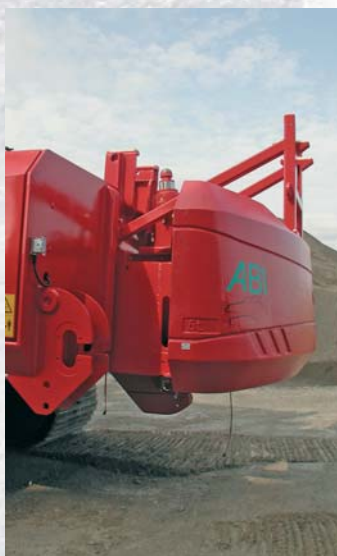
BANUT 555, контргруз с интегрированным вспомогательным устанавливающим цилиндром
