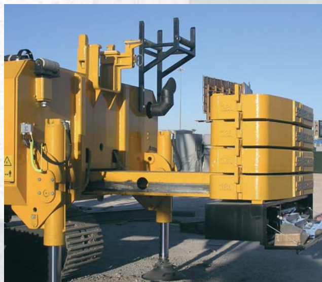
BANUT 650 с выдвинутым контргруз, 2-точечная опора и транспортная опора стрелы копра
